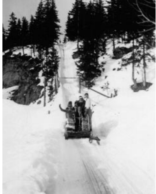
La luge articulée qui faisait monter les skieurs, les bobs et les lugeurs à Plans-Mayens entre 1924 et 1948.
